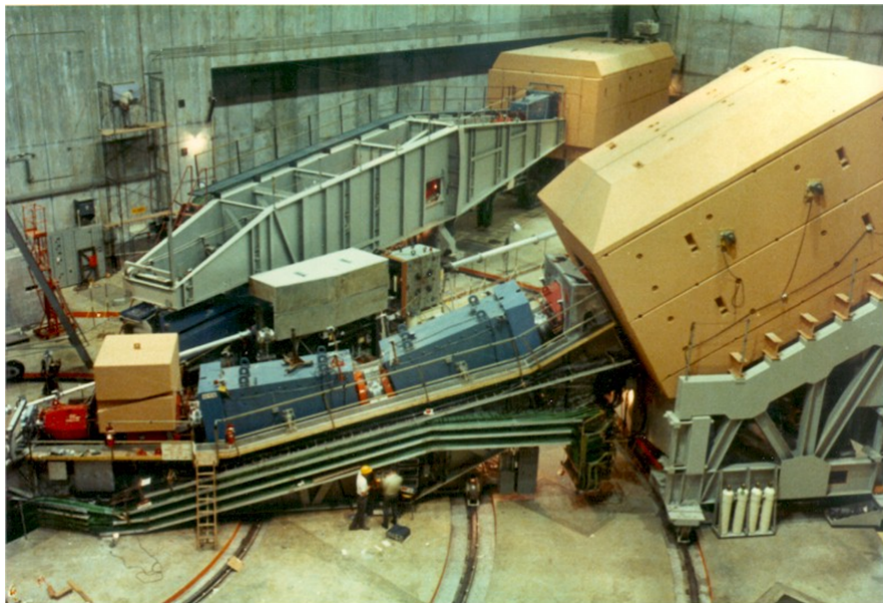
Abbildung VI.7: (oben) Prinzip Skizze (links) und des SLAC-MIT ep-Experiments und eine Skizze des 8-GeV-Spektrometerarms. (unten) Foto des SLAC-MIT-Experiments in der Experimentierhalle (Quelle: Taylor, DIS).
