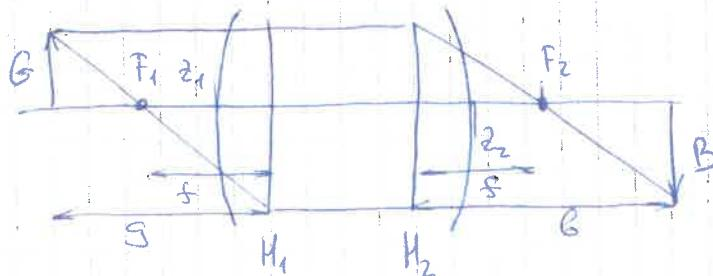
$$\begin{pmatrix} 1 & z_2 \\ 0 & 1 \end{pmatrix} \begin{pmatrix} 1 & 0 \\ -1/f_1 & 1 \end{pmatrix} \begin{pmatrix} 1 & z_1 \\ 0 & 1 \end{pmatrix} \quad \text{real lens}$$
