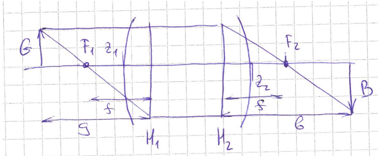
$$R = \begin{bmatrix} 1 & z_2 \\ 0 & 1 \end{bmatrix} \begin{bmatrix} 1 & 0 \\ -\frac{1}{f} & 1 \end{bmatrix} \begin{bmatrix} 1 & z_1 \\ 0 & 1 \end{bmatrix} = \begin{bmatrix} 1 - \frac{z_2}{f} & z_1 + z_2 - \frac{z_1 z_2}{f} \\ -\frac{1}{f} & 1 - \frac{z_1}{f} \end{bmatrix}$$
