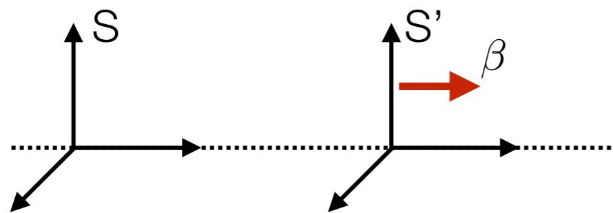
$$\begin{pmatrix} t' \\ x' \\ y' \\ z' \end{pmatrix} = \begin{pmatrix} \gamma & 0 & 0 & -\beta\gamma \\ 0 & 1 & 0 & 0 \\ 0 & 0 & 1 & 0 \\ -\beta\gamma & 0 & 0 & \gamma \end{pmatrix} \begin{pmatrix} t \\ x \\ y \\ z \end{pmatrix}$$
