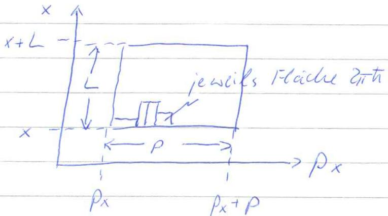
$$\text{dann wird } g(E) = \frac{dN}{dE} = 2 \frac{dN}{dp} \frac{dp}{dE} = \frac{L}{2\pi\hbar} \sqrt{\frac{m}{2E}} = \frac{L}{2\pi\hbar c} \sqrt{\frac{mc^2}{E}}$$
